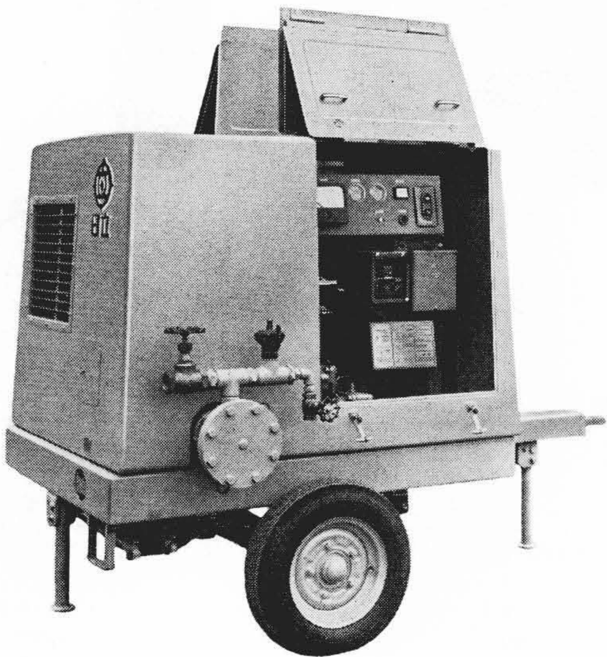
第 4 図 3 形電動式ポータブルコンプレッサ
