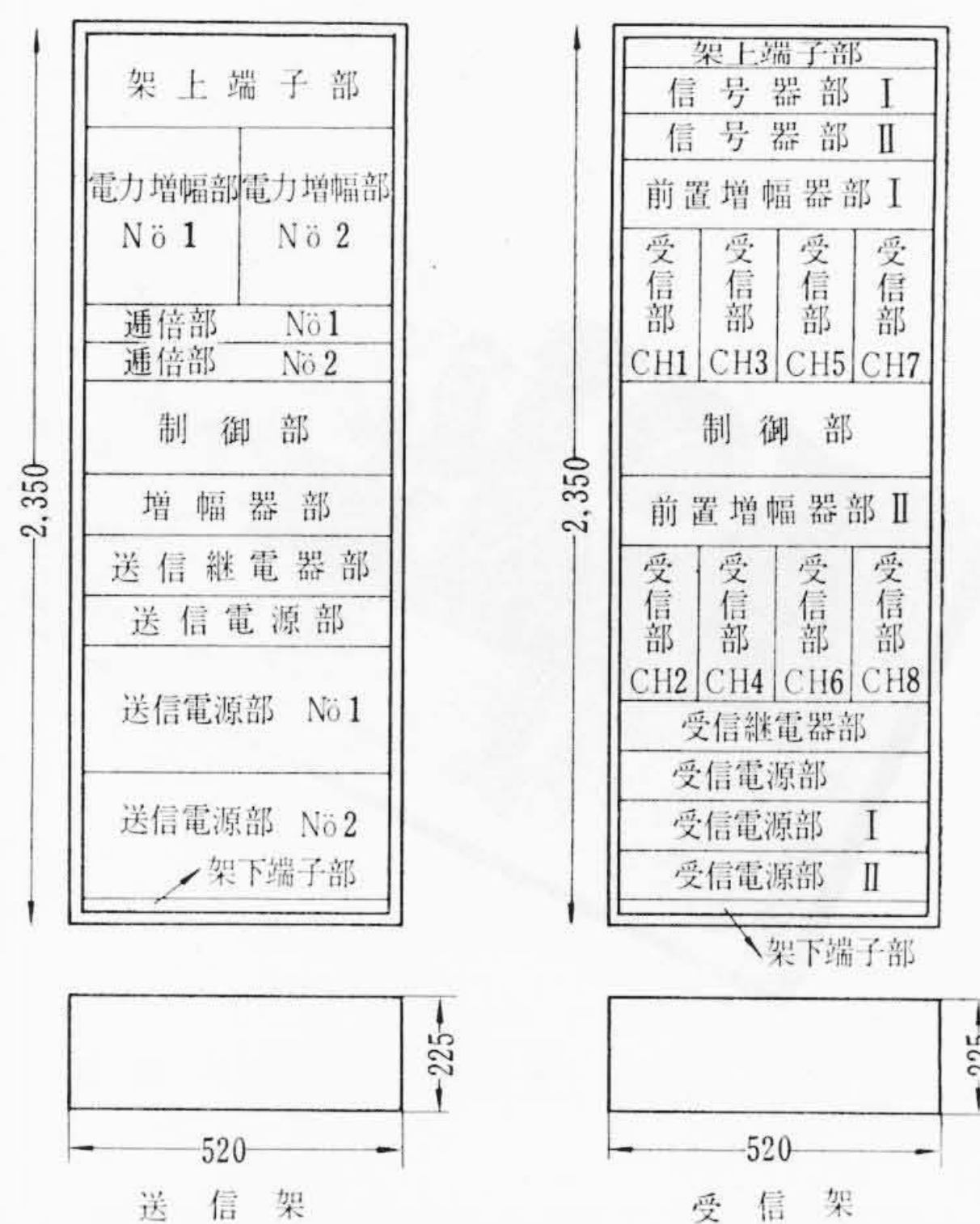
第8図 無線架パネル実装図
