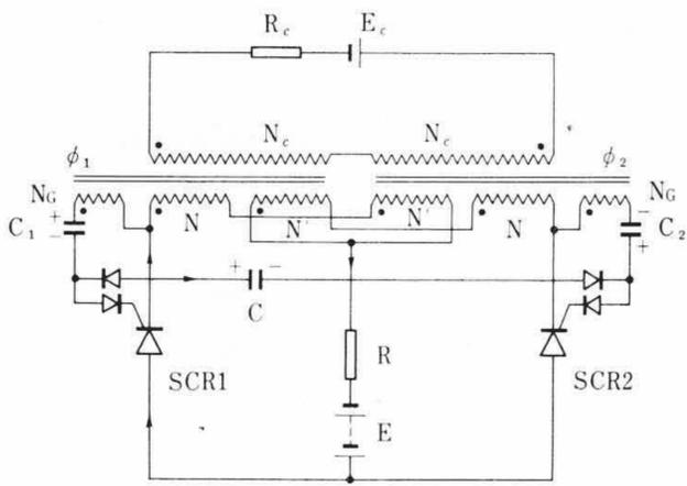
第 1 図 SCRを用いた直流電源で動作する磁気増幅器
