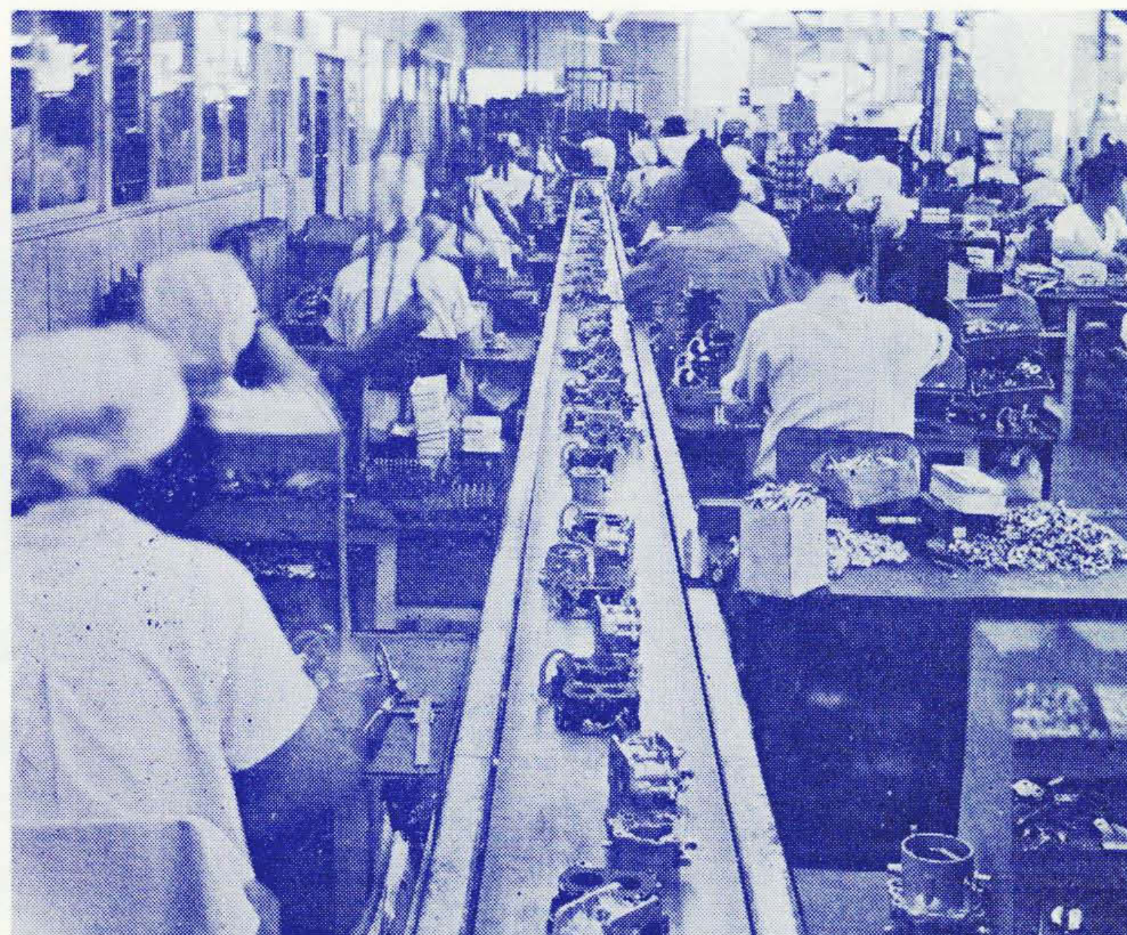
第24図 量産されるいすゞベレット1600GT用新形気化器
