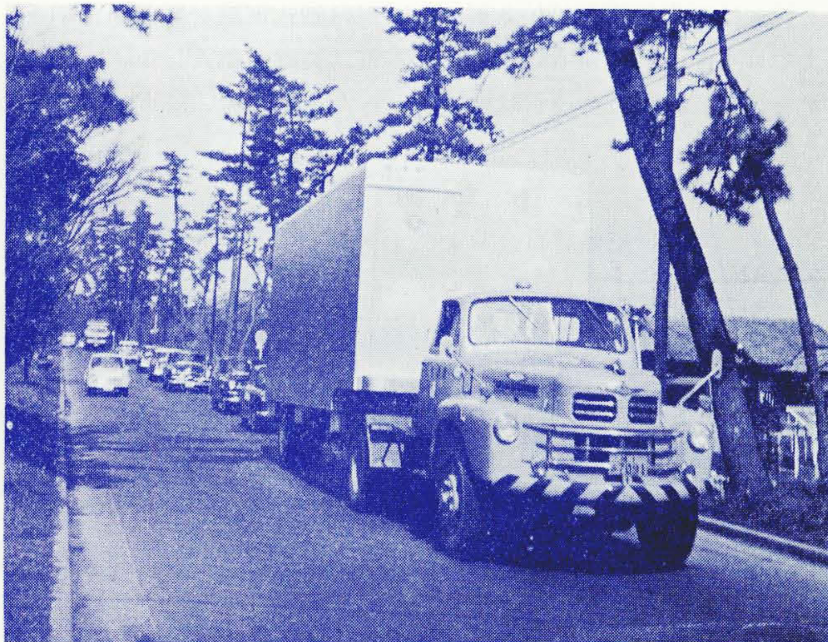
第17図 日本電信電話公社平塚田村局納可搬形大形交換装置
