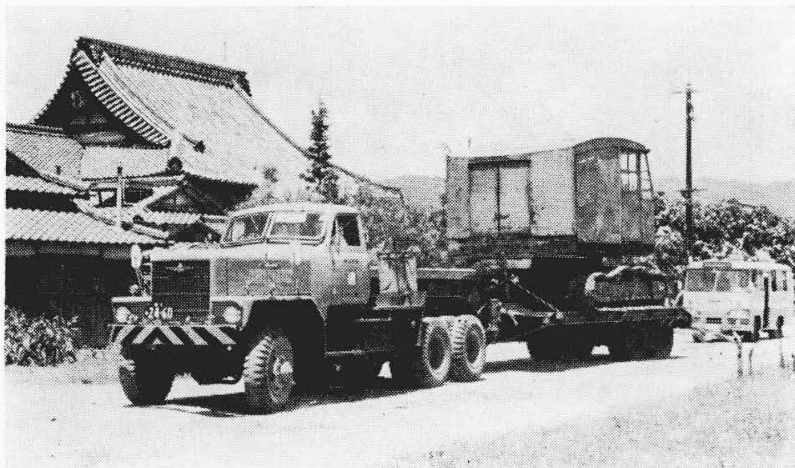
第 8 図 パワーショベル積載方法
