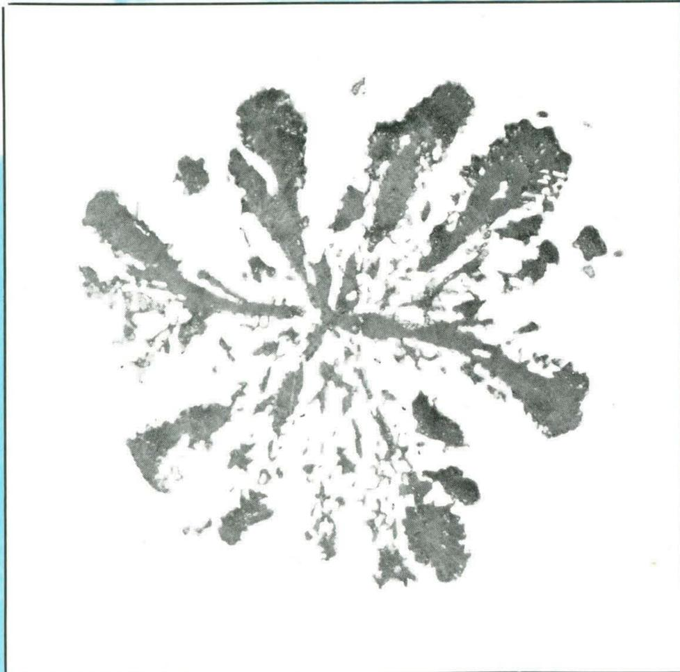
鑄鉄中の黒鉛はそれを適当な球状化処理することにより球形に近づく。しかし、その処理方法のいかんによっては、いろいろな変形組織がみられるようになる。
