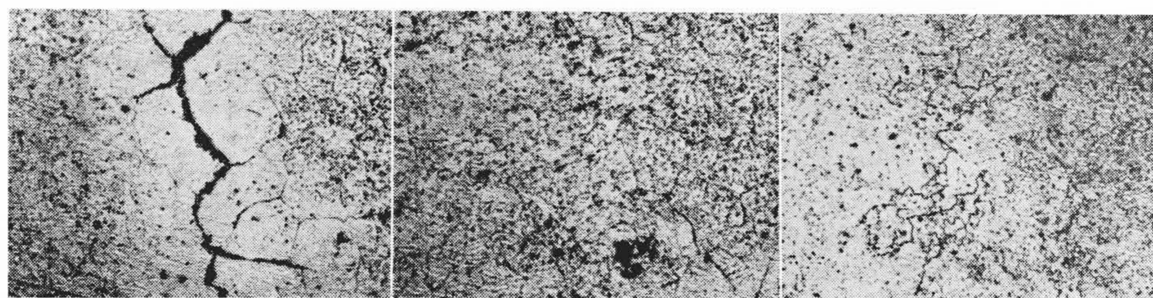
溶着部←→熱影響部 粗粒熱影響部 溶着部←→熱影響部 細粒熱影響部 (4) 鋼C 溶接部 500°C, 200 kg/cm 2 , 100 h 水素中加熱後の組織(第4図(4)の組織, 切断, 粗粒熱影響部)
