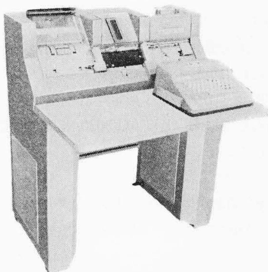
第13図 H-163 形ケン盤 カードセン孔機
