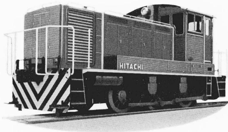
第8図 ハルドアガンジ火力発電所納35 t ディーゼル機関車
