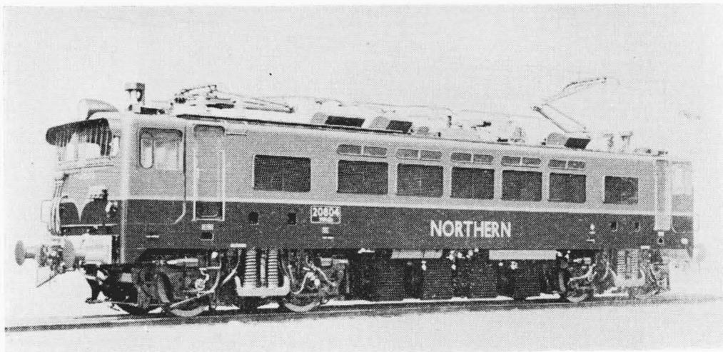
第1図 インド国鉄納25kV 2,400kW WAG<sub>2</sub>形交流電気機関車
