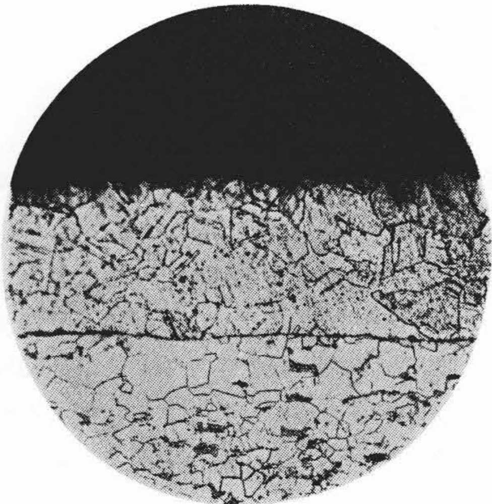
第2図 CFCクラッド材の銅と軟鋼の接着界面 (×100)
