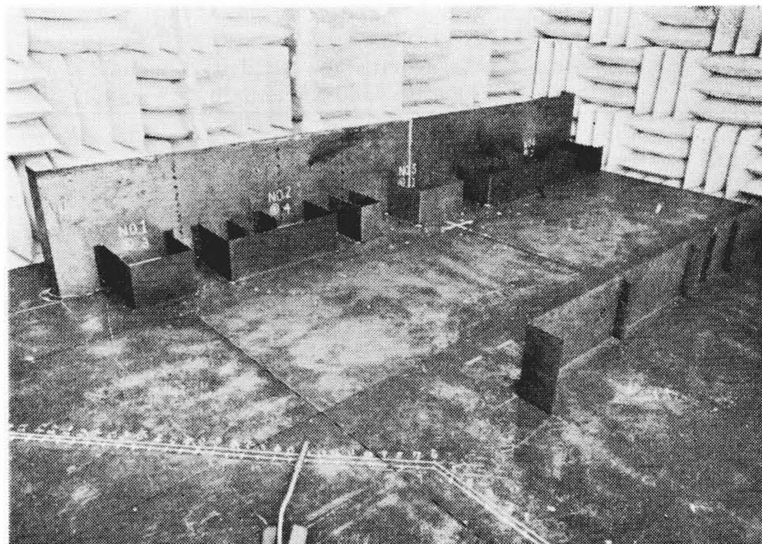
第14図(a) 騒音分布のモデル実験装置
