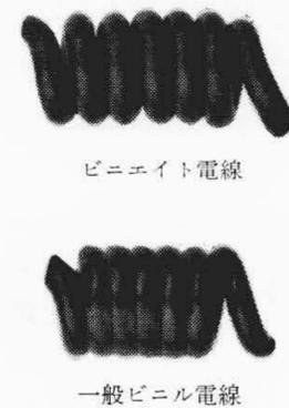
第3図 ビニエイトおよび一般ビニル電線の 200℃ における巻付試験結果
