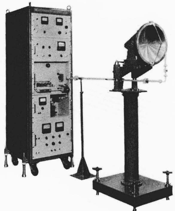
図1 50 Gc 帯プラズマ温度測定用受信装置および細ビームアンテナ
