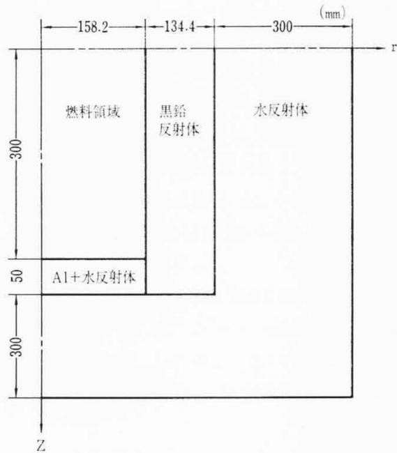
図7 12本炉心の円柱二次元モデル化
