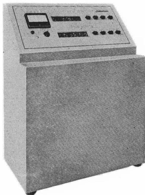
図2 2軸零点移動全けた付表示装置
