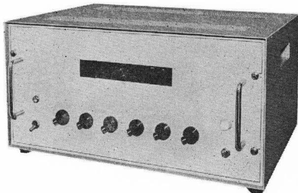
図1 零点移動全けた付表示装置
