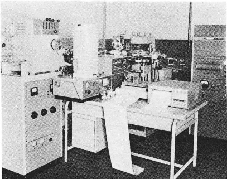
図2 質量分析計—ガスクロマトグラフ直結分析装置
