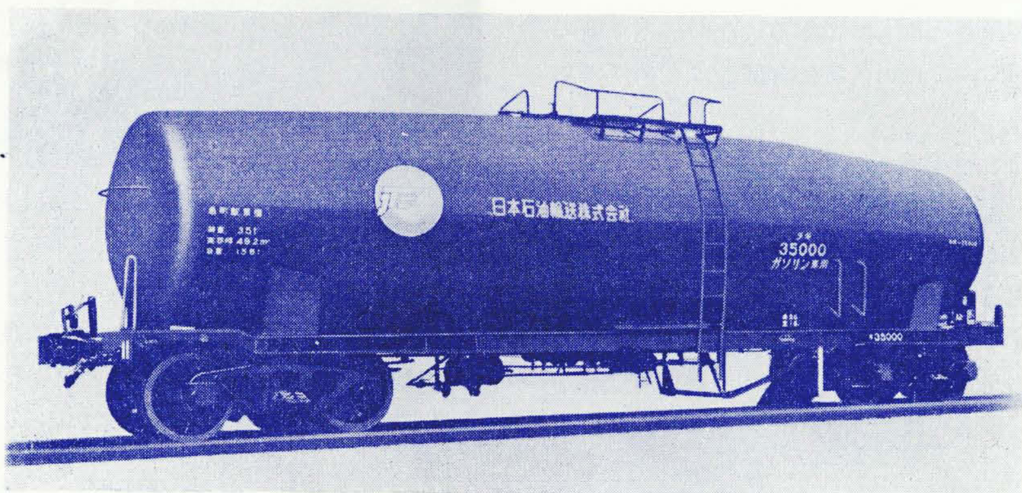
図6 標準形35t積ガソリタンク車
