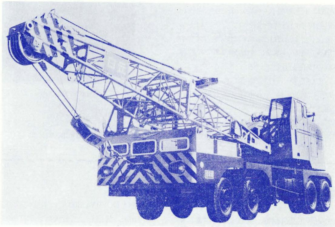
図8 F125形 35t 吊トラッククレーン
