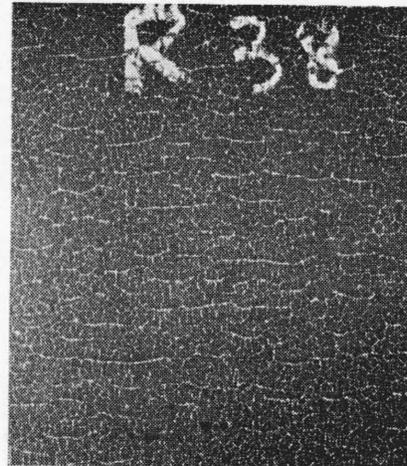
図1 ホットストリップ粗ロールの表面クラック (改良前)
