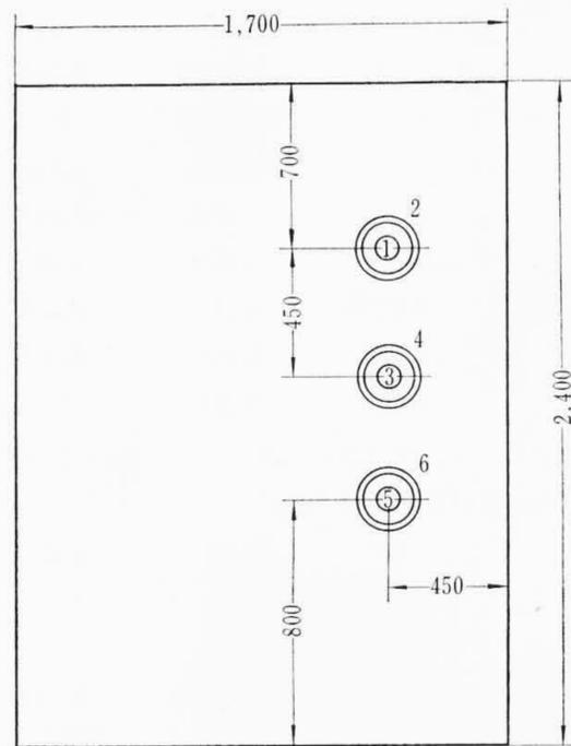
図3 洞道内ケーブル配置
