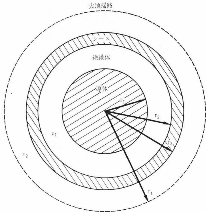
図2 直埋布設の断面
