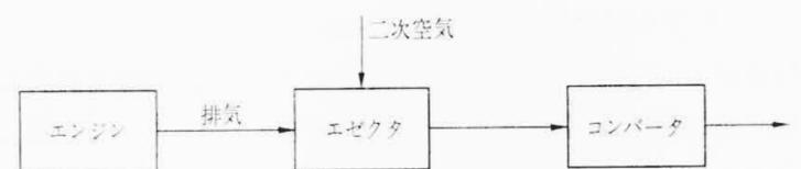
図 1 触媒式排気ガス浄化装置系統図
