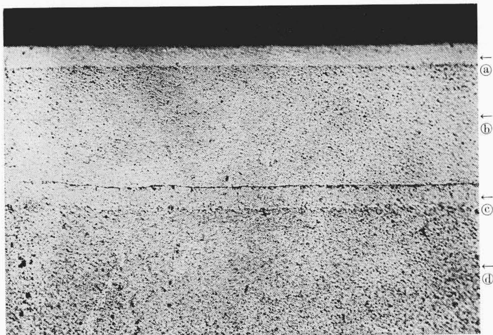
【(a) 銀 (b) 銅 (c) アルミはんだ】銀コンタクトワッペン (d) アルミ母材
