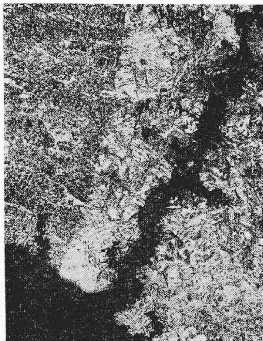
ルート部より HAZ 部へはいった割れ状況
