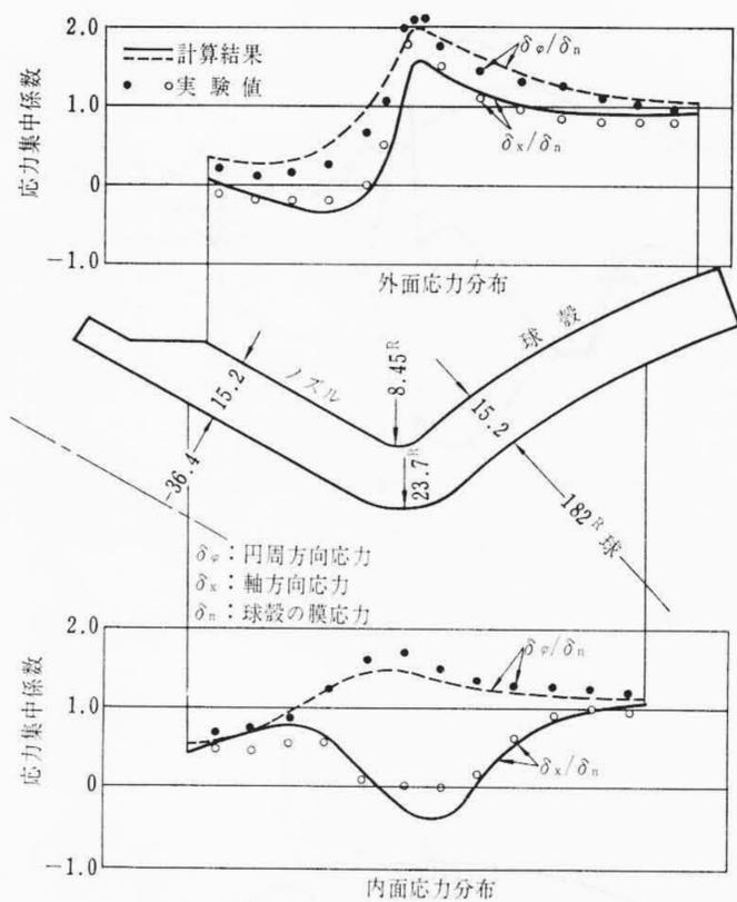
図7 ノズルの内圧による応力分布
