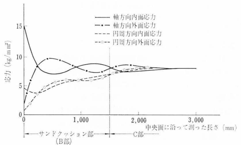
図13 サンドクッション部の内圧力による応力
