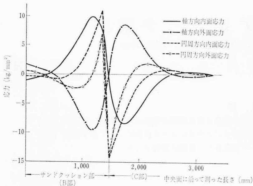
図14 事故直後のサンドクッション部の熱応力
