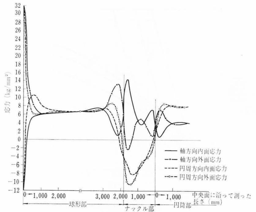
図11 ジェット力および内圧による上鏡部の応力
