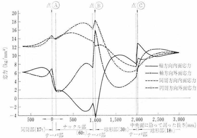
図9 ナックルおよびその付近の内圧による応力
