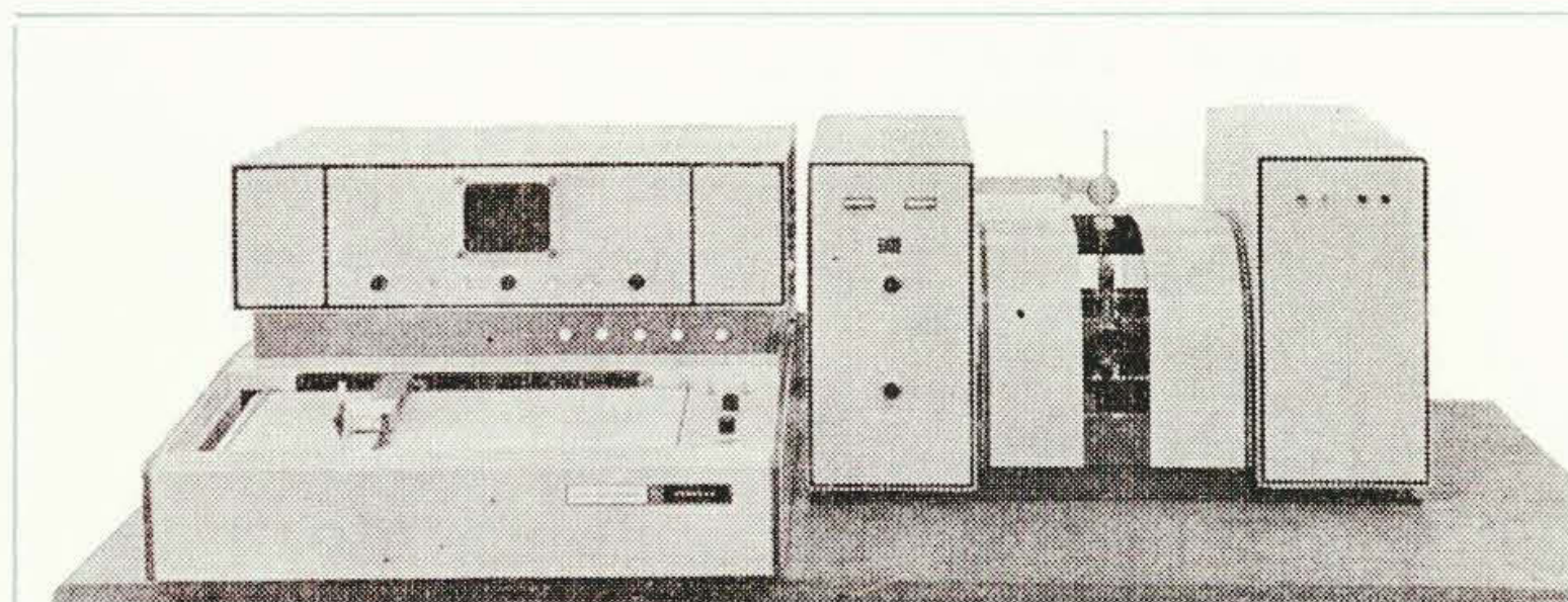
図9 771 形電子スピン共鳴装置
