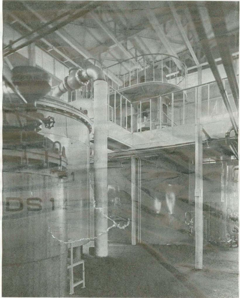
図2 世界最大の 300 m<sup>3</sup> 培養槽
