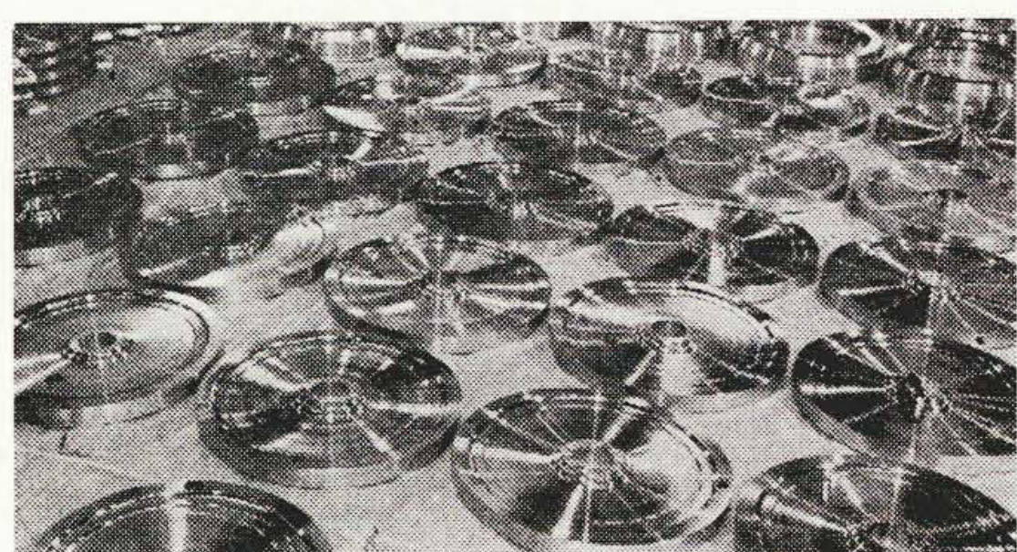
図9 石川島播磨重工業株式会社航空エンジン事業部納 J79-IHI-11A ターボジェットエンジン用
