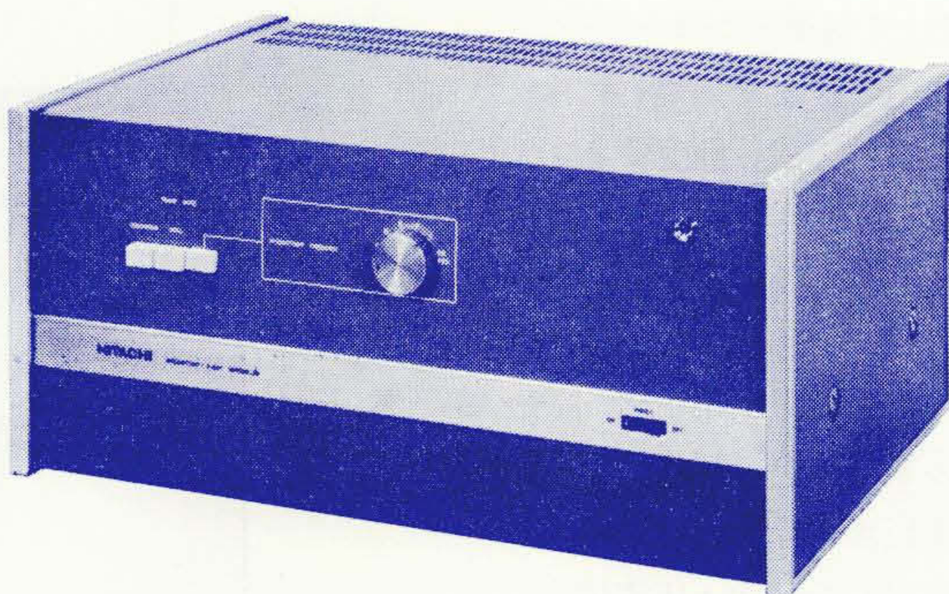
図6 透視X線量減少装置
