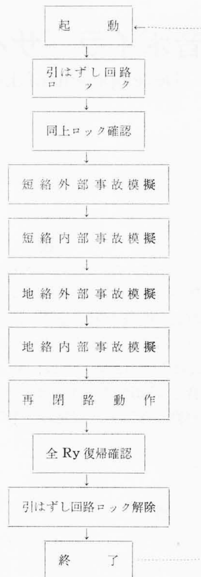
図18 距離継電装置の点検フロー図
