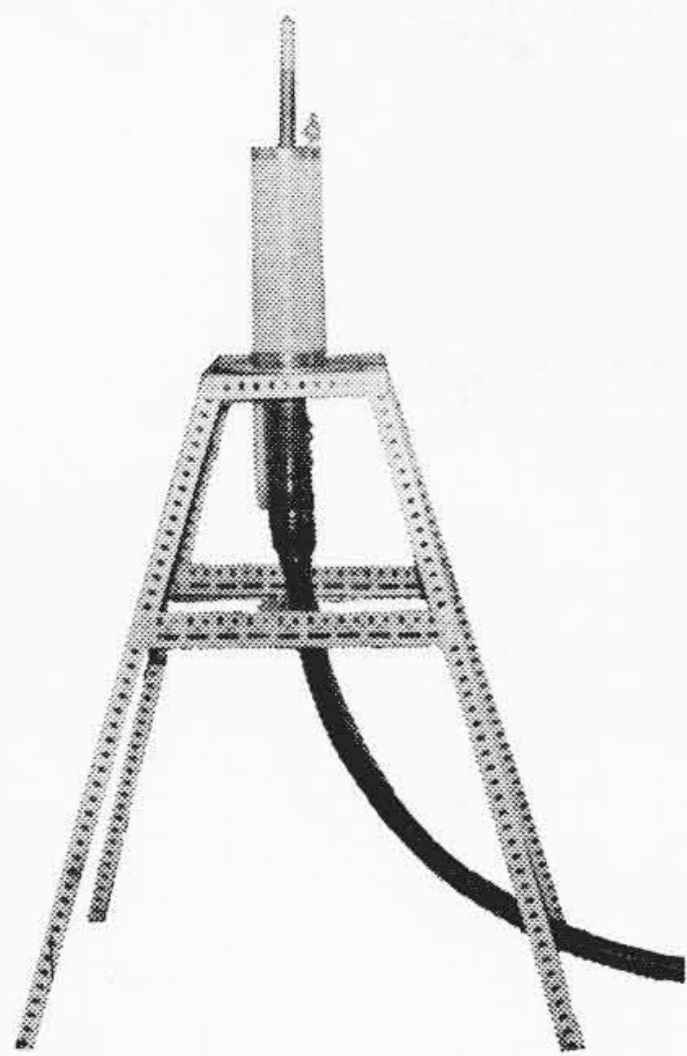
図 12 水冷端末内部
