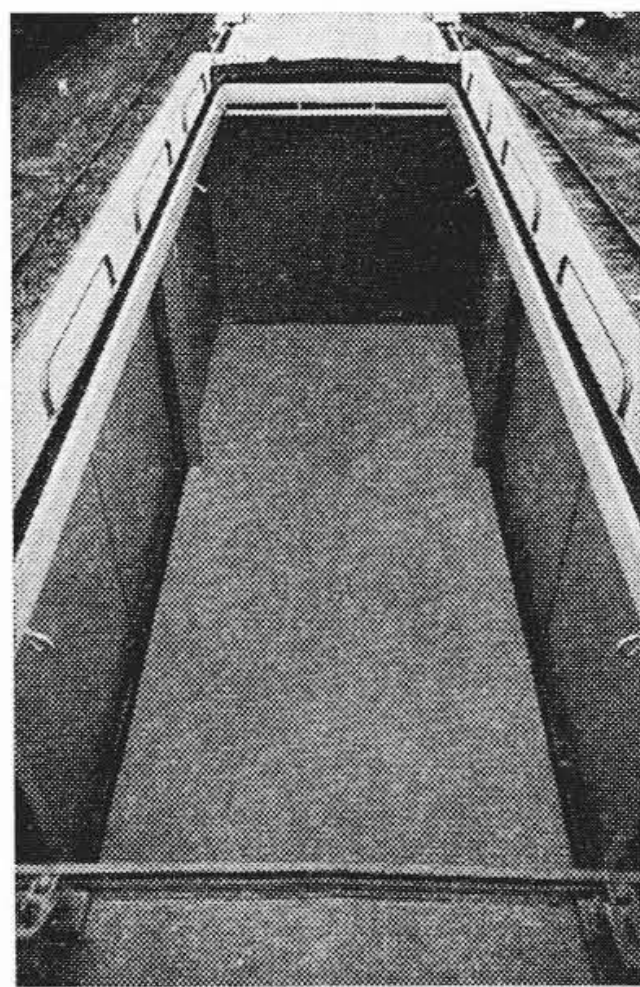
図 2 屋根とびらを全開した状態
