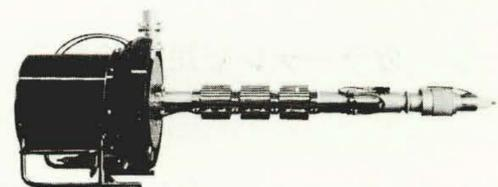
図2 UHF大電力進行波管1W31
