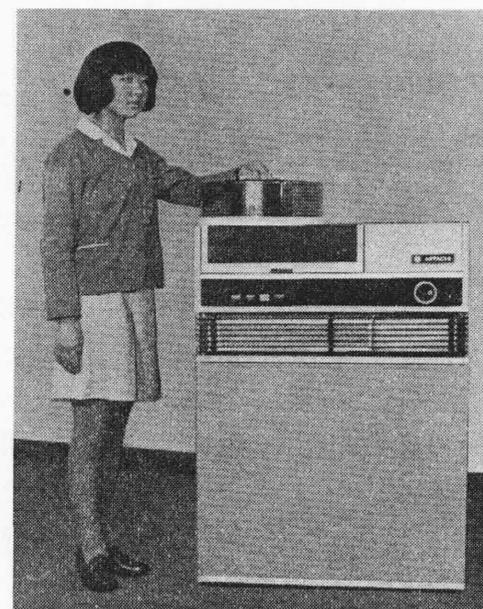
図 1 大容量ディスク記憶装置の駆動部
