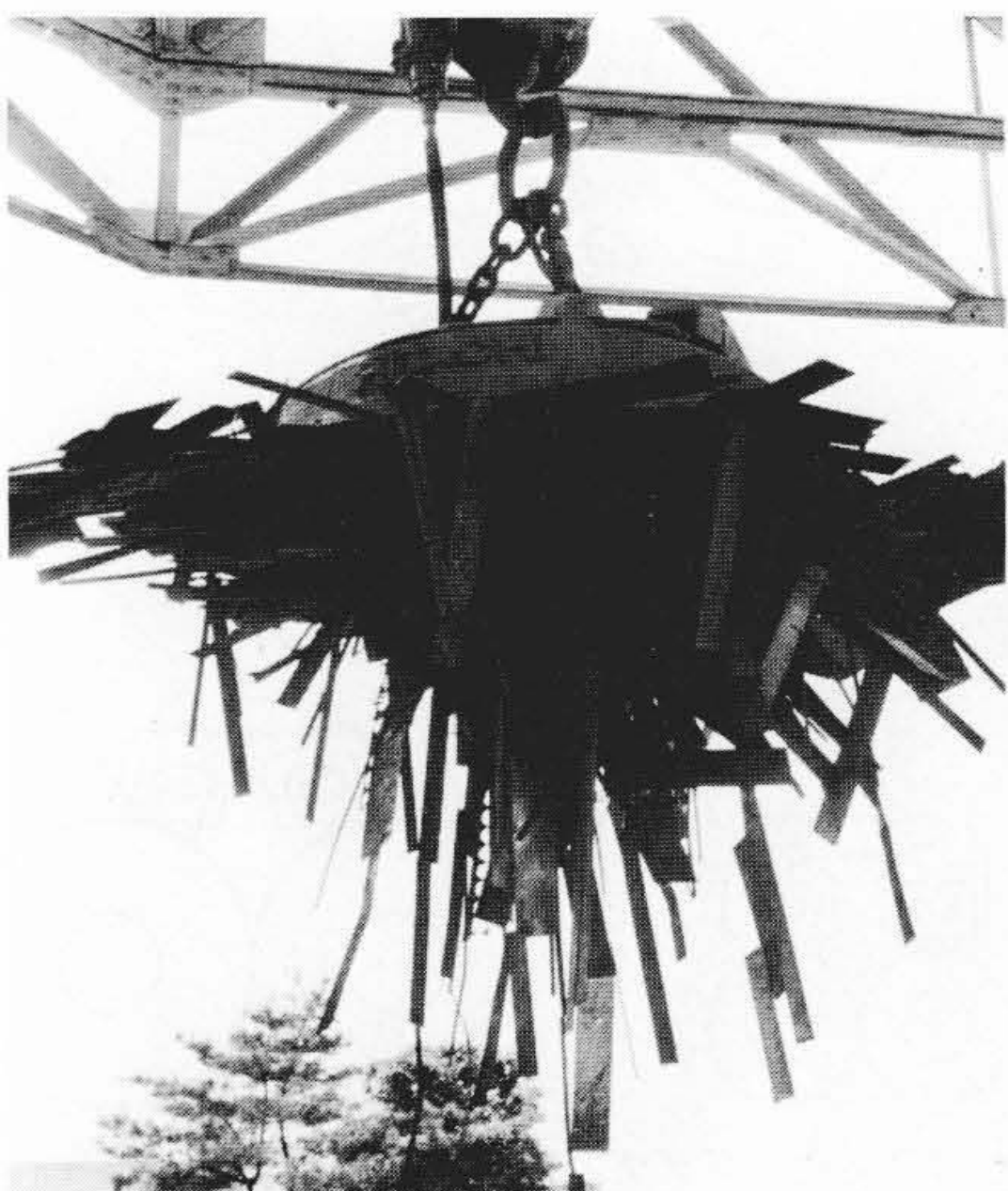
図14 不整形スクラップ運搬中のLM-R113ハイリフト
