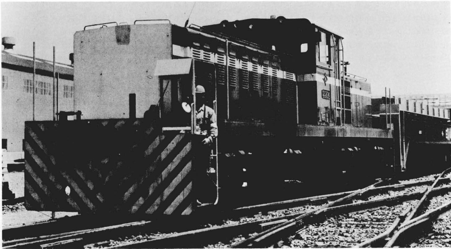
図4 リモコン式ATO (ATOR) 従来、乗務員、誘導連結手、ポイント切換手の3名で運用していたが、ATORの採用によりワンマン化されている。
