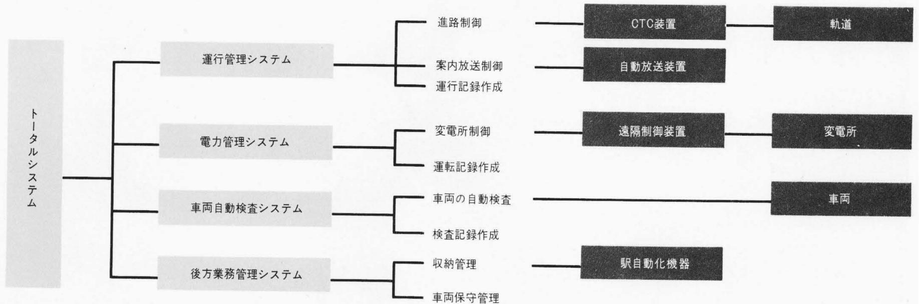
図1 トータルシステム機能構成図 札幌市交通局高速電車コンピュータ・トータルシステムは、4サブシステムより構成され、おのおのの計算機システムによって、トータルシステムとしての有機的結合が図られている。
