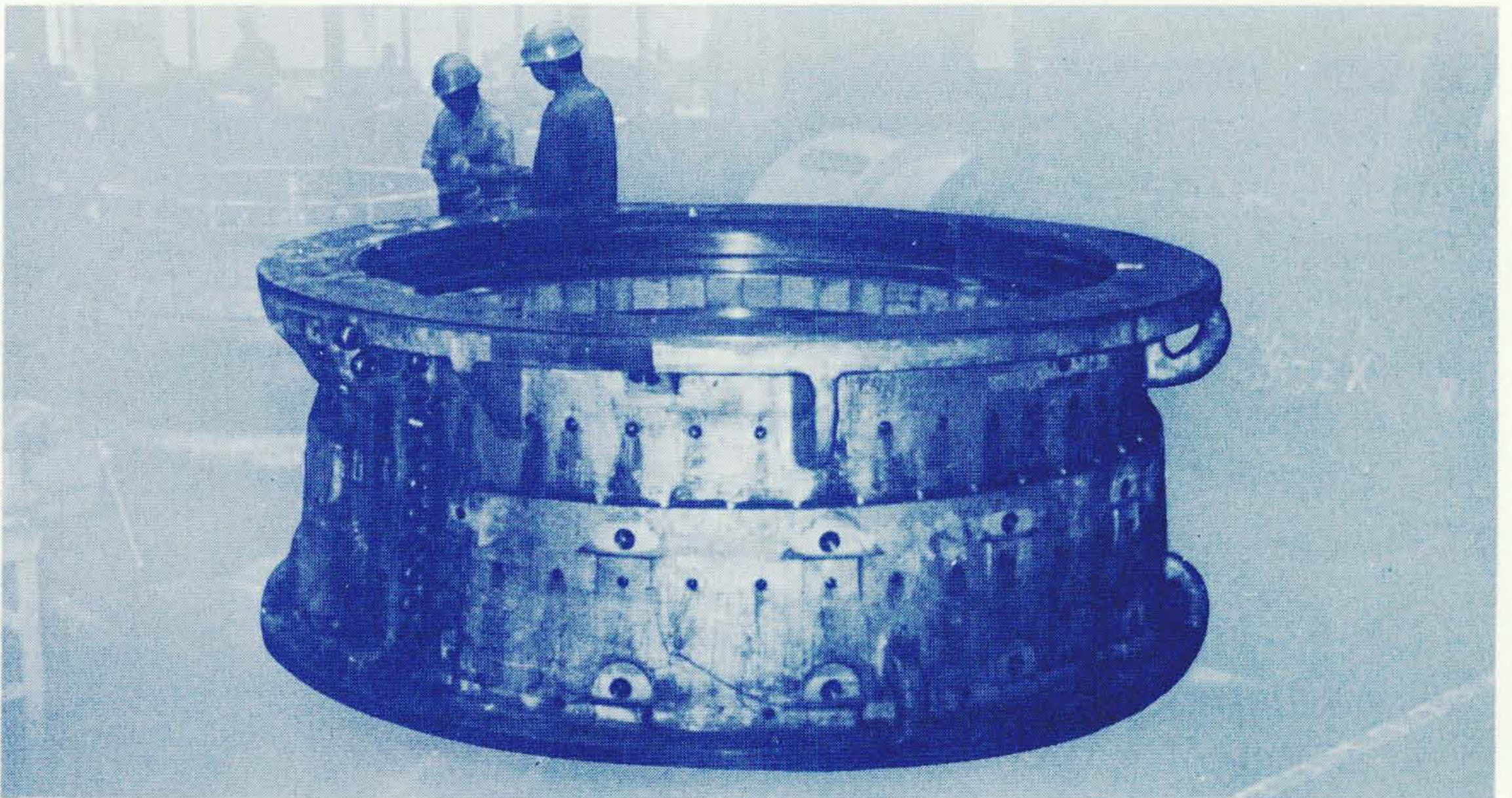
図2 組立中のガスタービンケーシング
