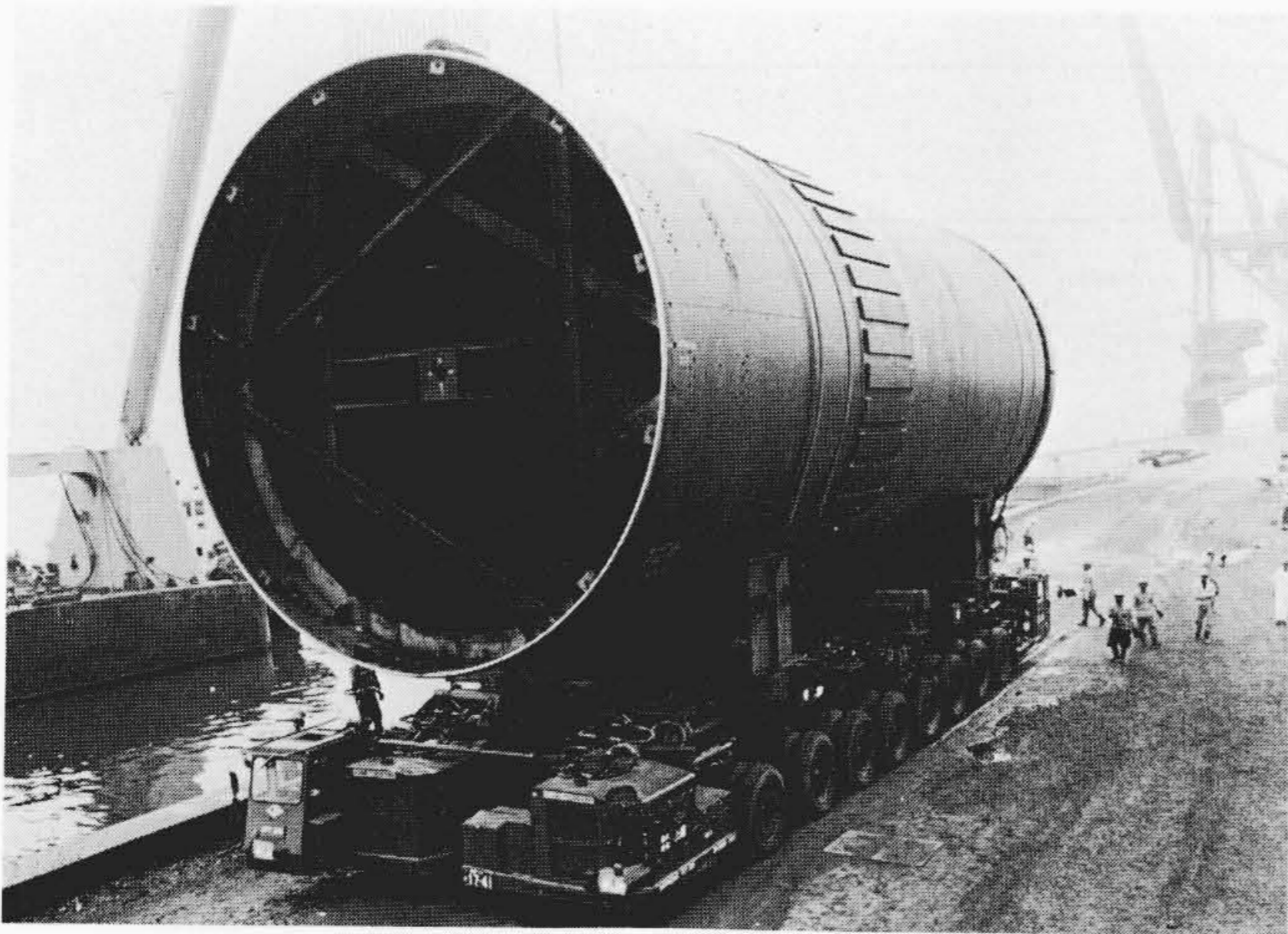
(200t自走車を2台連結) 図2 400t自走車の外観
