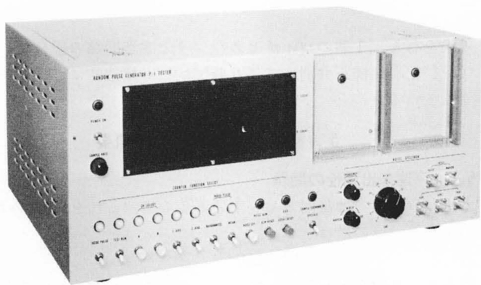
図10 2進乱数プラグインパネル試験器
