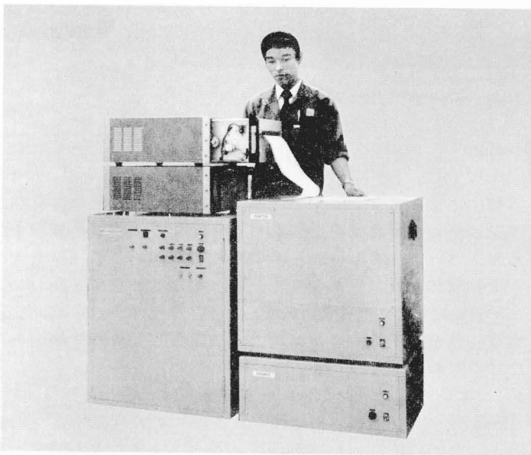
図6 エレベータ交通需要測定装置 時々刻々、ビル内のすべてのエレベータ交通需要がリアルタイムで専用コンピュータで分析され、ラインプリンタにより出力される。
