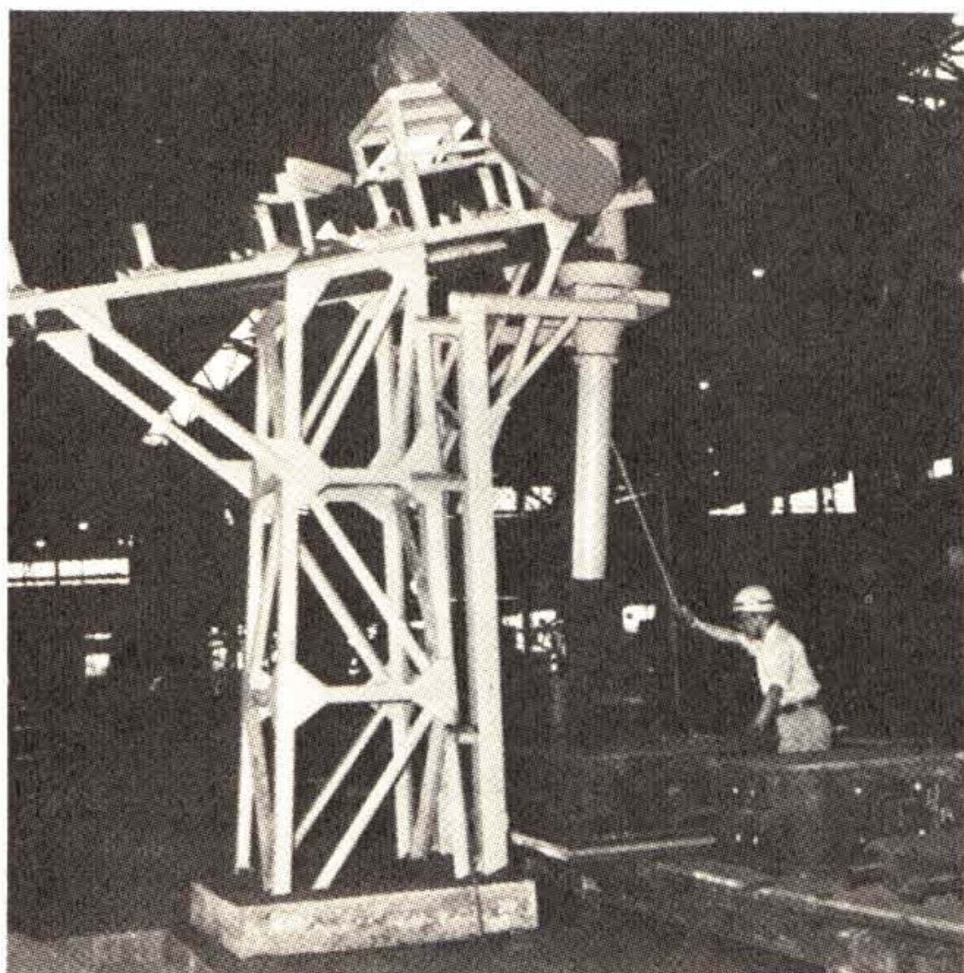
図18 スーパNプロセス砂の注入状況
