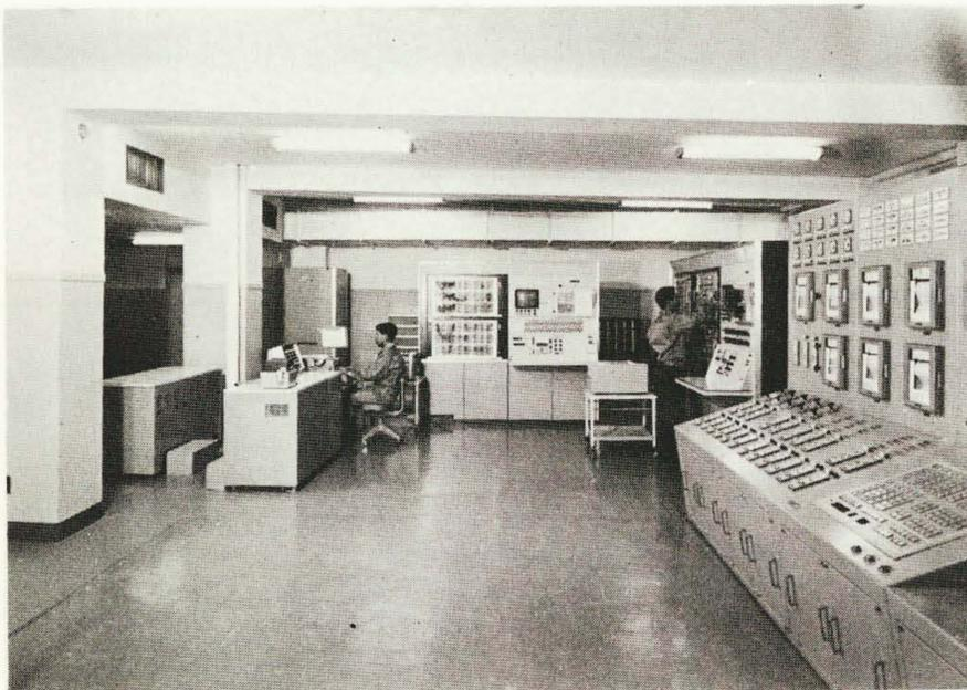
図19(a) 火力総合全自動化シミュレータ機器動特性模擬装置
