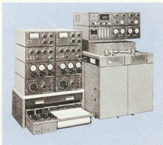
図38 073形ダブル恒温槽ガスクロマトグラフ
