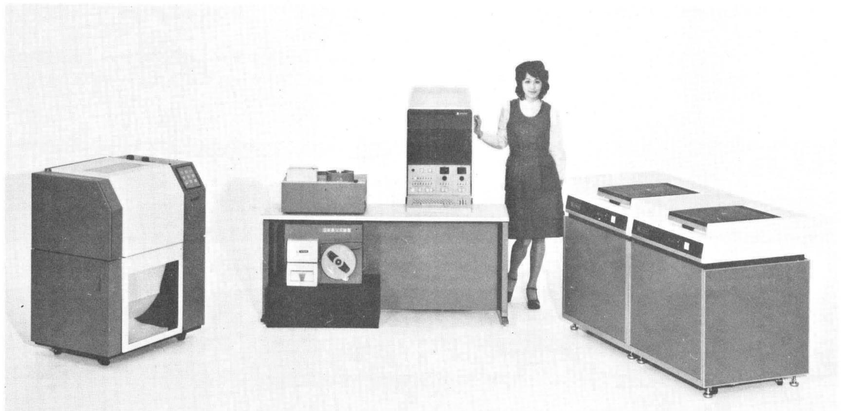
図1 HITAC 8150システム 標準構成システム外観写真を示す。
