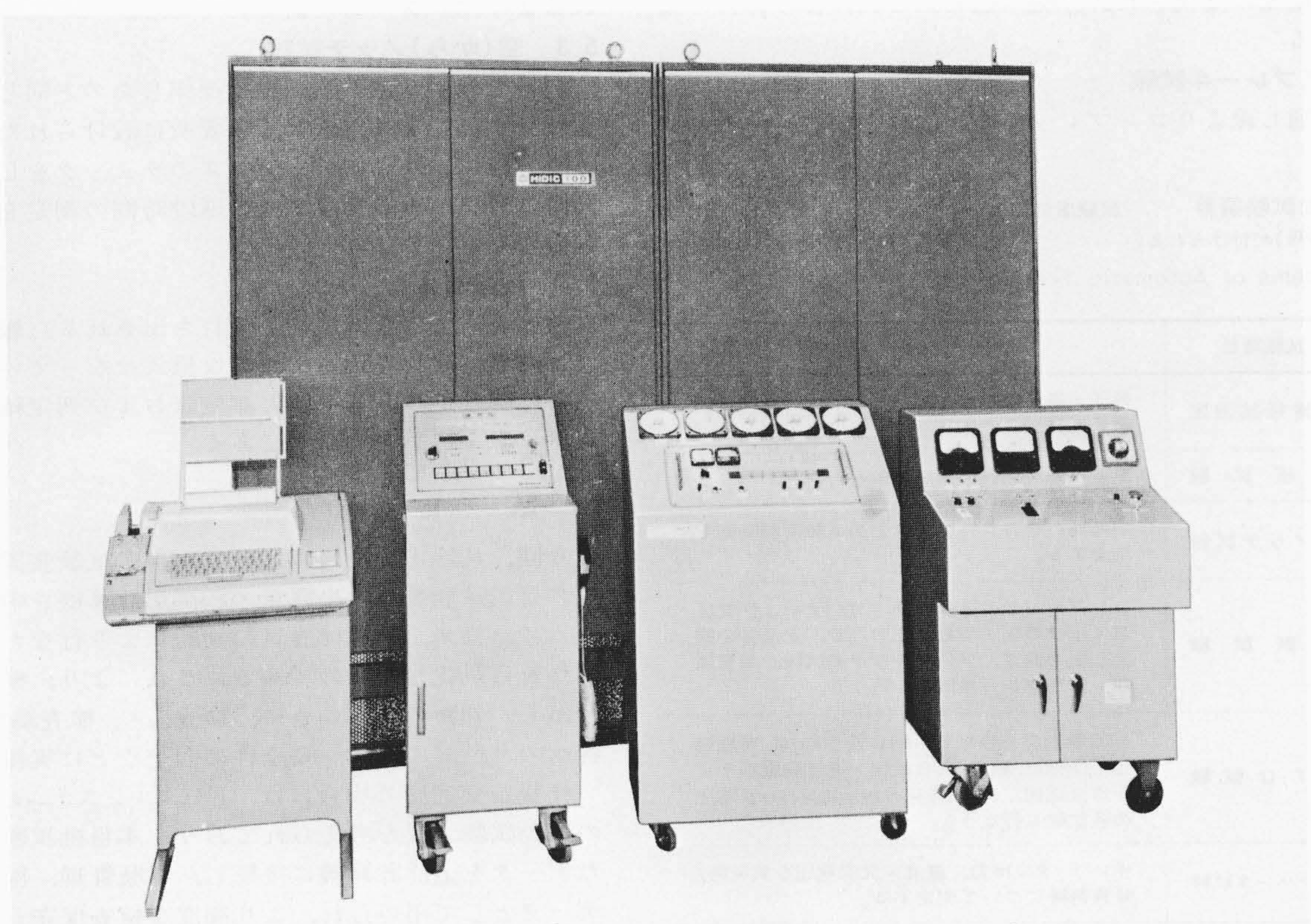
図3 電車自動試験装置の主要機器 前列左よりデータライタ、操作盤、空制試験器(電気部)、耐圧試験器、後列左はHIDIC 100 制御用計算機およびプロセス入出力装置、右はリレー箱を示す。 Fig.3 Equipment of Automatic Car Tester
