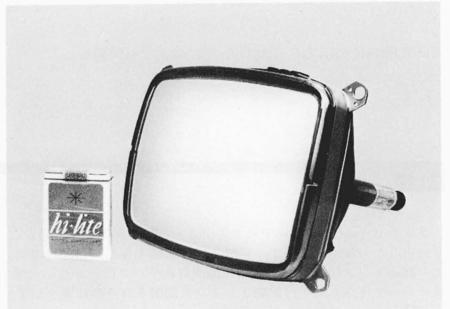
図7 250XB22カラー受像管の外観 ゲルマニウムトランジスタで偏向系を動作させることができる。
