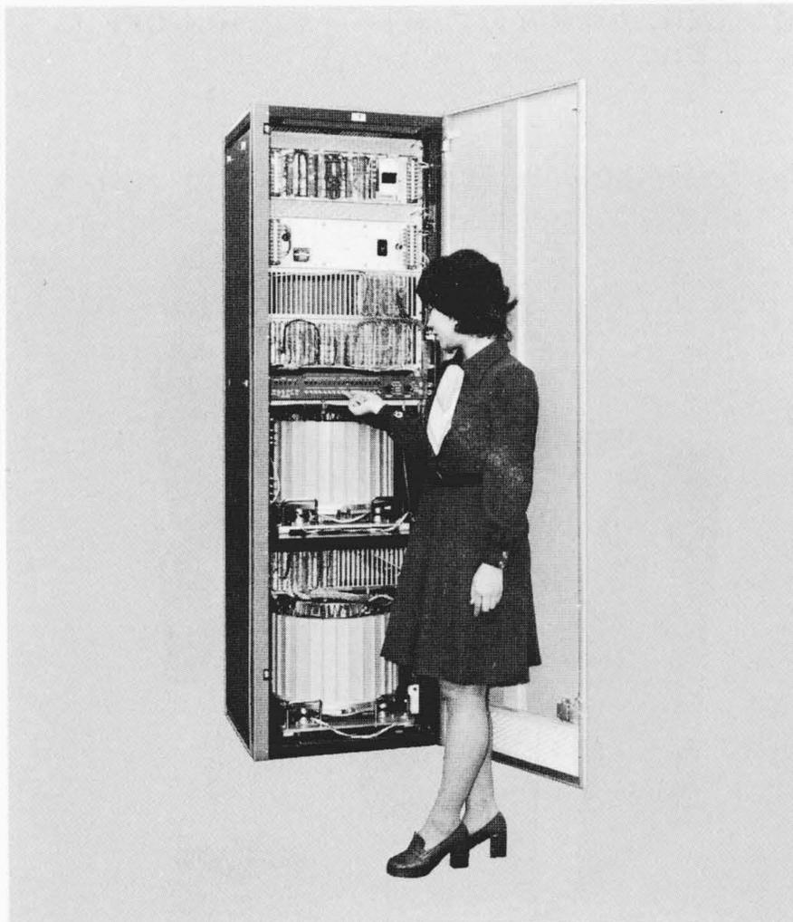
図3 H-7541磁気ドラム装置 HIDIC標準インタフェース、1,536kWの磁気ドラム装置を示す。
