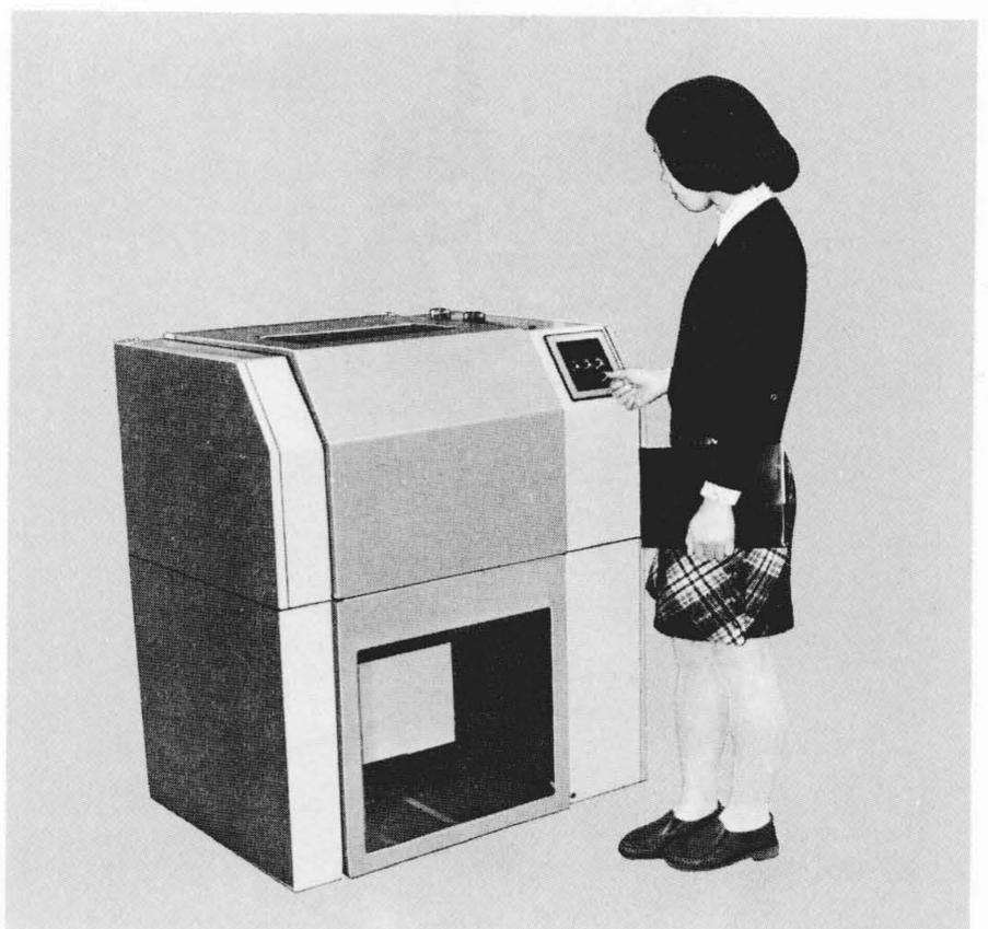
図6 H-7031ラインプリンタ 印字速度300/150行/分のラインプリンタの外観を示す。
