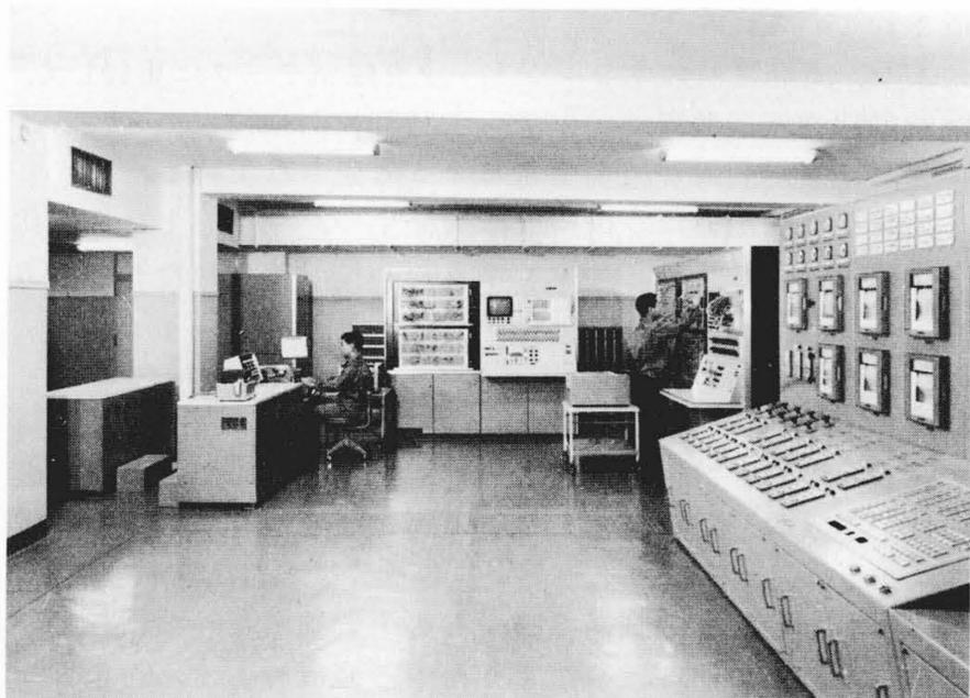
図3 機器動特性模擬装置 アナログ計算機と専用デジタル計算機のハイブリッド構成となっている。
