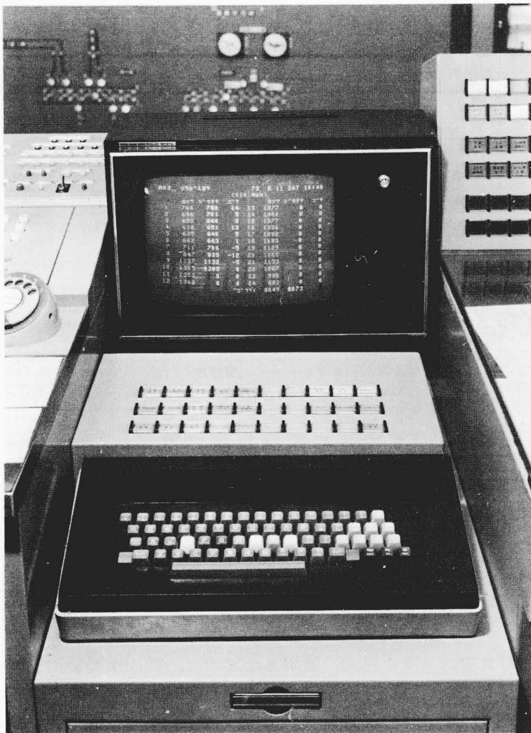
図2 CRTおよびCRTコンソール CRTの前面にキーボードとCRTコンソールを配置して操作を容易にしている。
