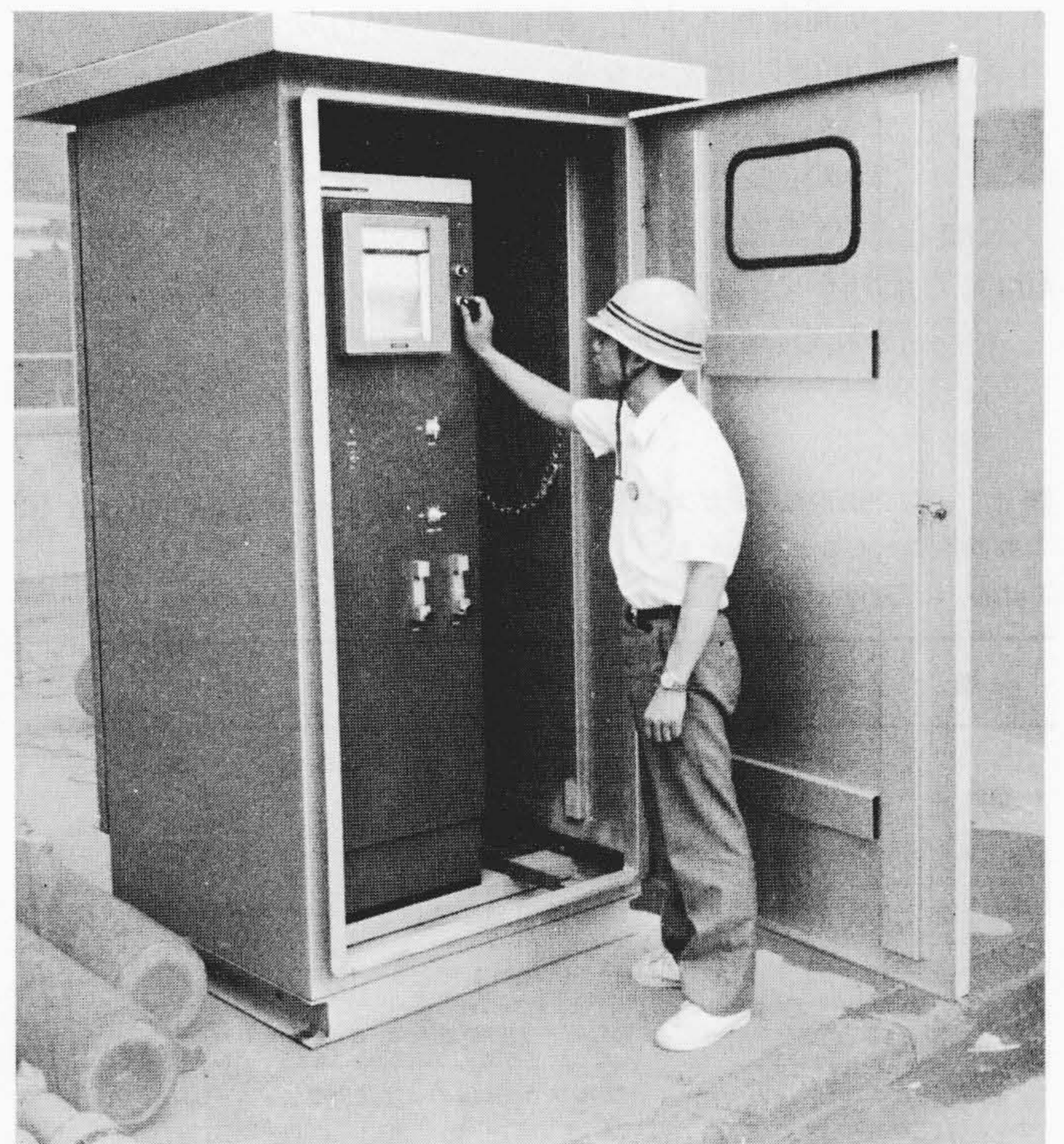
図1 AN250形窒素酸化物ガス濃度計 前面においてガス流路切換、電子回路調整など操作できることを示している。
