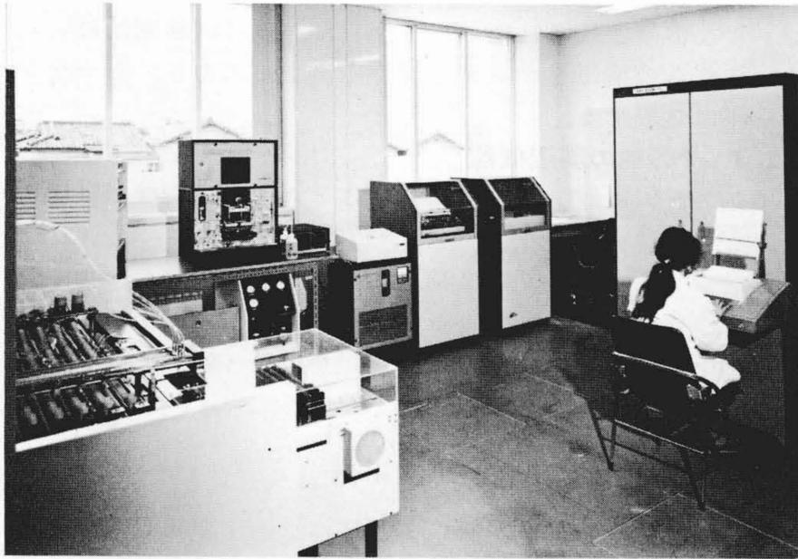
図3 東京都立衛生研究所納め“HILAS-TX” 自立密閉キュービクル2面とテレタイプライタ, 出力タイプライタおよびカセットテープ入出力装置から成り, 400形自動分析装置(左端)とコールタカウンタS形分析計(中央左寄り)が同一室内に設置されている。
