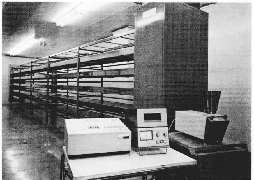
図4 毒性検査動物飼育室 実験動物は, 幅11×高さ1.9×奥行0.57(m)の飼育たなで約400匹飼育され, 移動台車に載せられたてんびんで体重, 給餌量が随時測定される。
